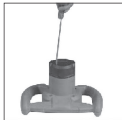
Cortar la corriente primero, desmontar la carcasa del motor.
